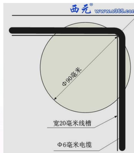
宽20毫米线槽拐弯处最小弯曲半径
