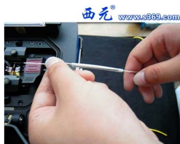
安装热缩保护管
