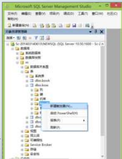
图10-3 菜单方式建立触发器
