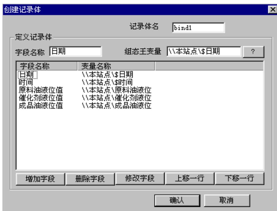
记录体定义了组态王变量\$日期、\$时间、原料油液位、催化剂液位、成品油液位和 Access 数据库表格中相应字段日期、时间、原料油液位值、催化剂液位值、成品油液位值之间的对应连接关系。(注意：记录体中的
