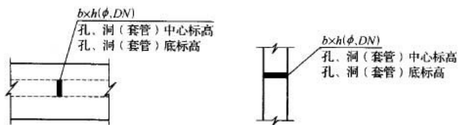
图 3.3.4 预留孔、洞及预埋套管的表示方法
