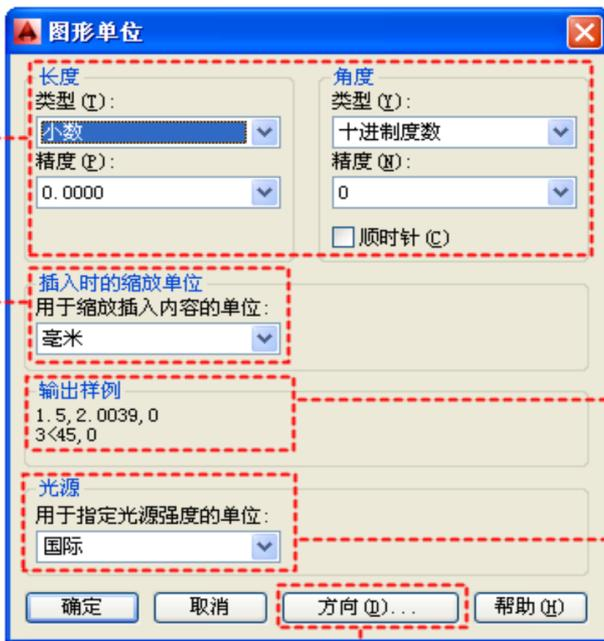
“方向”按钮：单击该按钮，系统显示“方向控制”对话框，如图 3-2 所示。可以在该对话框中进行方向控制设置。
