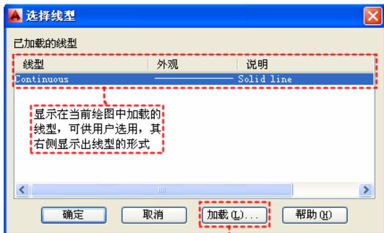
单击此按钮, 打开“加载或重载线型”对话框, 如图 3-18 所示, 用户可通过此对话框加载线型并把它添加到线型列表中, 不过加载的线型必须在线型库 (LIN) 文件中定义过。标准线型都保存在 acad.lin 文件中
