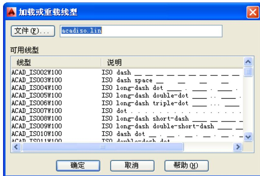
图 3-18 “加载或重载线型”对话框
