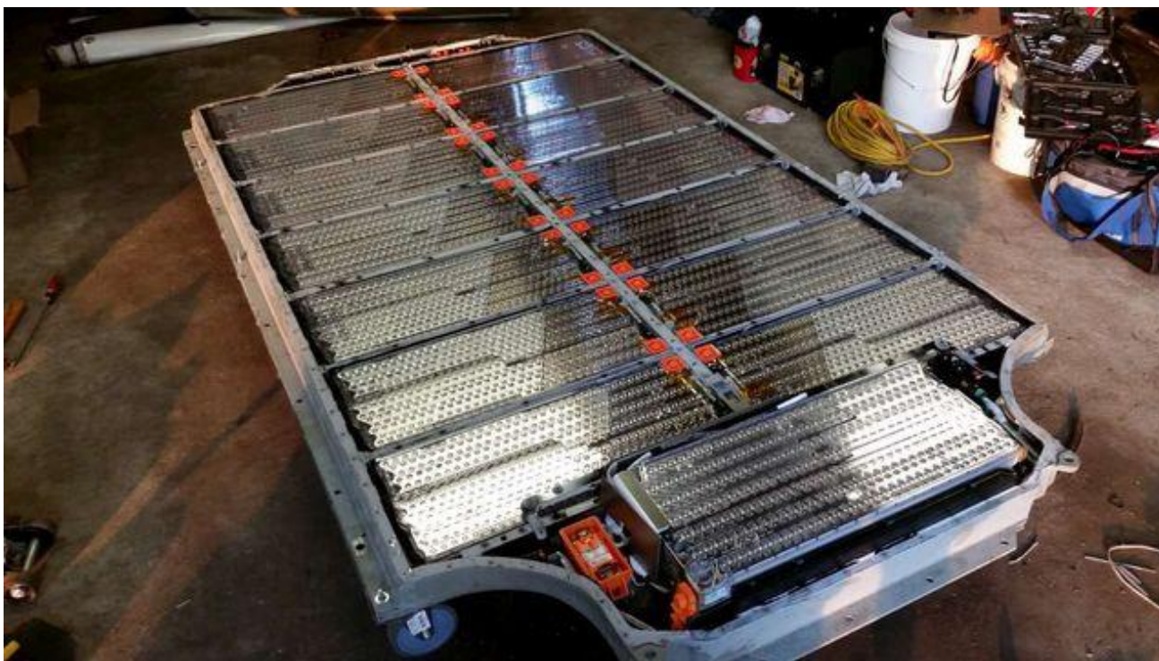
特斯拉电池组内部的16个电池包（85kWh）
