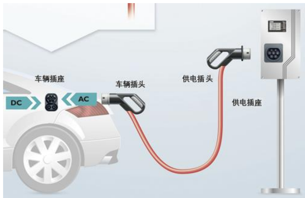
图4-10 车载充电机与充电电源连接
