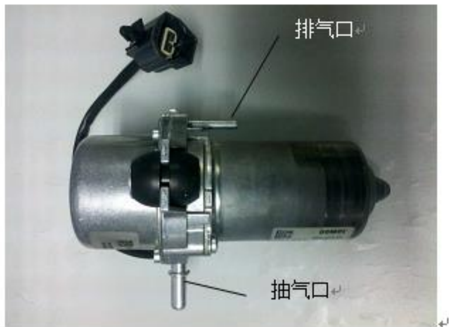
北汽E200电动汽车制动系统电动真空泵
