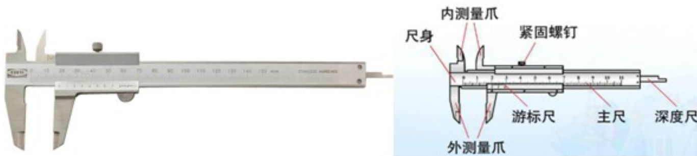
图 2-3 游标卡尺外形及结构
