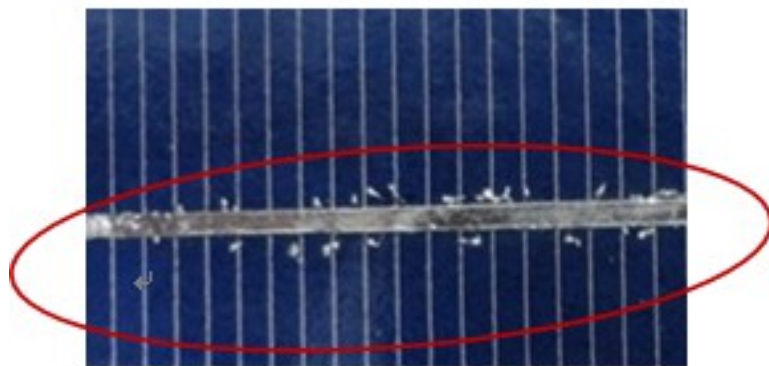
图 2-47 电池片上有锡丝、焊点
