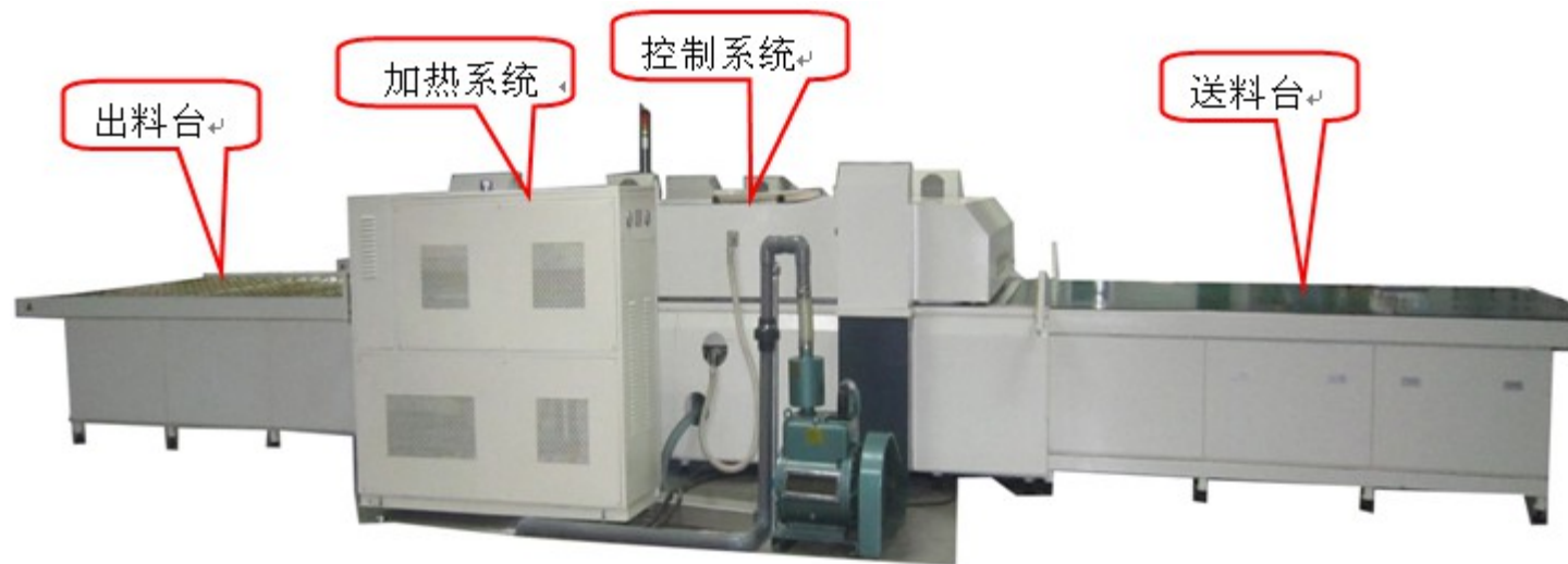
图 2-97 层压机的结构
