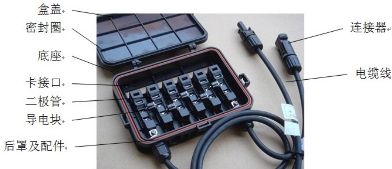
图 2-123 卡接式接线盒基本结构
