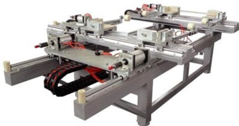
图 2-118 光伏组件装框机
