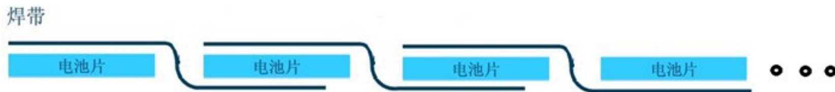
图 2-59 太阳能全自动焊接机焊接原理示意图
