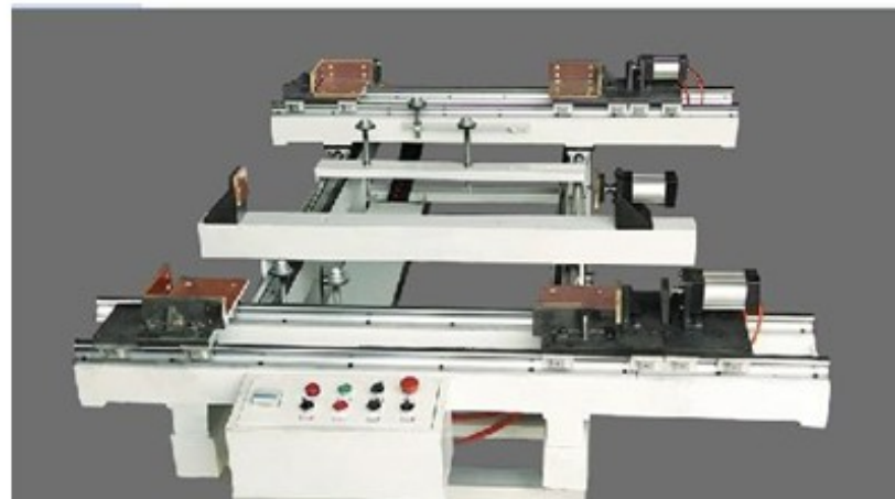
图 2-118 光伏组件装框机
