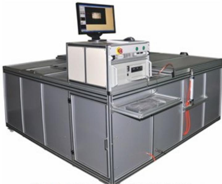
图 3-8 太阳能电池组件缺陷测试仪
