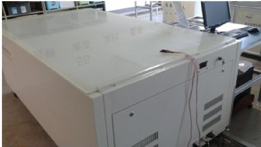
图 3-2 光伏组件测试仪
