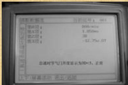
图7-11 怠速时节气门开度显示
