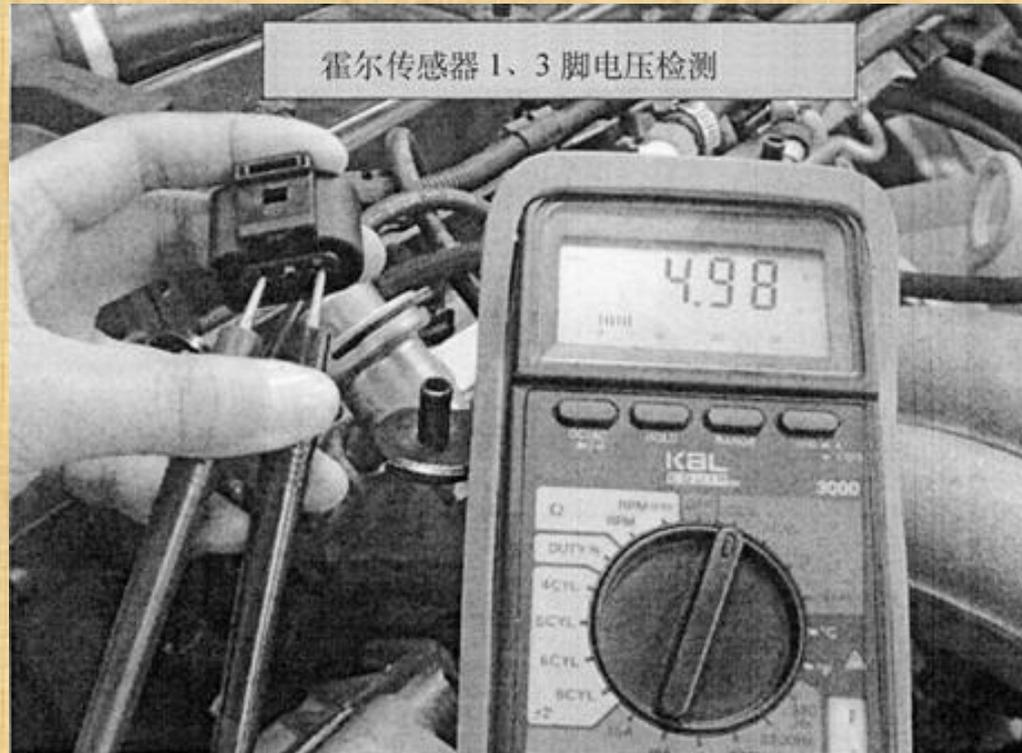
图8-5 霍尔传感器1、3脚电压检测
